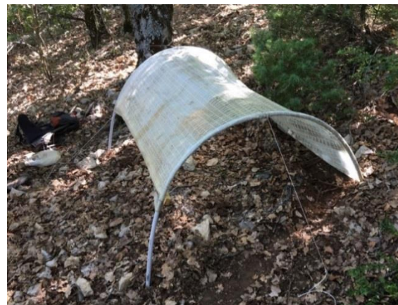
Figure 6.1 : Photo d'une mini-exclusion de pluie couvrant un des quatre blocs dans lesquels étaient disposés les sachets de litière. Une bâche transparente et une tranchée en amont de la pente protégeaient les sachets de litière contre la pluie et le ruissellement. La circulation de l'air est assurée par des ouvertures sur les trois côtés sur quatre du dispositif. (Photo G. Ayache).
